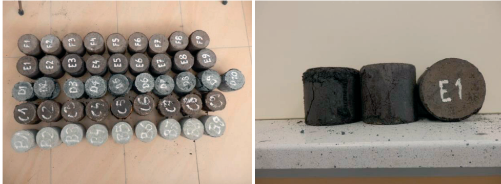
Fot. 1. Próbki \text{Ø}80 \times 80 mm po badaniu wytrzymałości na ściskanie osiowe
