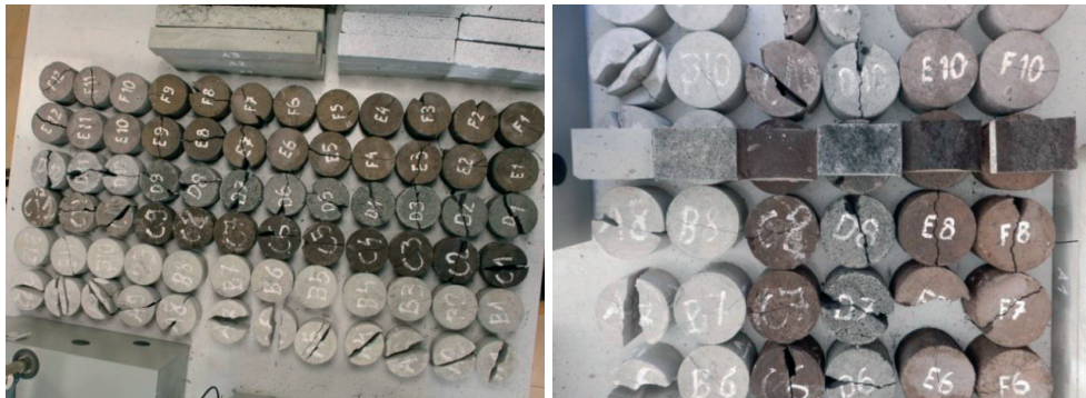
Fot. 2. Próbki \text{Ø}100 \times 63,5 mm po badaniu wytrzymałości na pośrednie rozciąganie
