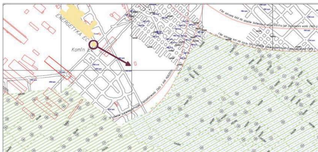
Rys. 10. Położenie komina i kierunek jego wychylenia na tle otaczającej eksploatacji górniczej prowadzonej w latach 2003-2014
