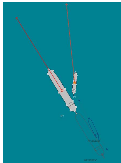
Rys. 7. Efekt działania klina wody podczas podejścia statków, przy niezachowaniu równoległego położenia obu jednostek.
