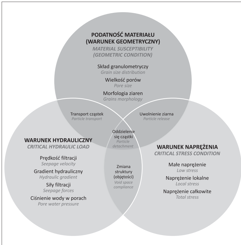
Ryc. 4. Czynniki powodujące deformacje filtracyjne gruntów (Dąbska, 2021; zmodyfikowane wg Garner, Fannin, 2010)
