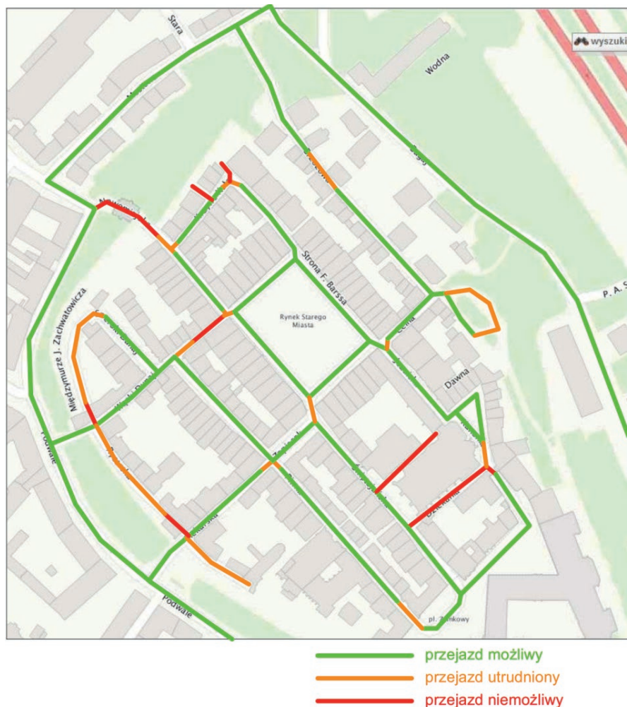
Rycina 4. Plan Starego Miasta w Warszawie z oznaczoną przejezdnością dróg pożarowych
