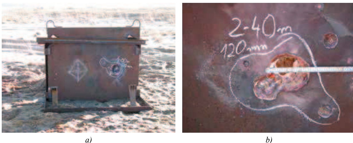
Rys. 6. Płyta pancerna o grubości 120 mm po próbach przebicia: a) nieudanej, b) udanej
