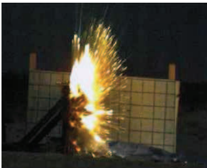
Rys. 4. Moment uderzenia pocisku o płytę pancerną
