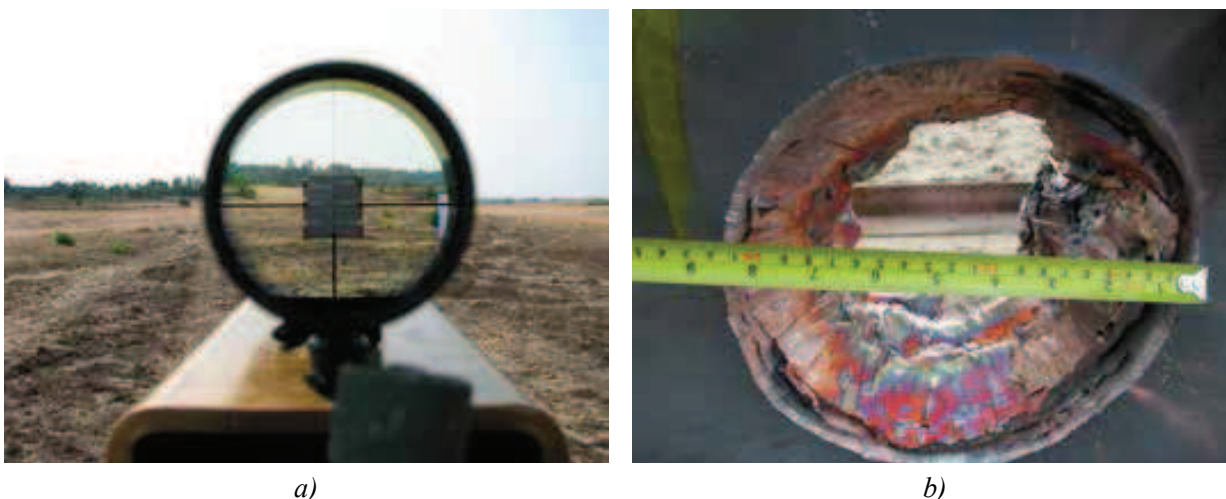
Rys. 9. Badania poligonowe ładunku EFP: a) celowanie, b) przebicie płyty pancernej
