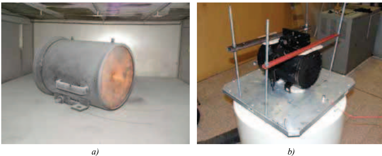
Rys. 8. Ładunki EFP podczas sprawdzeń laboratoryjnych: a) odporność na obniżoną temperaturę, b) odporność udary mechaniczne
