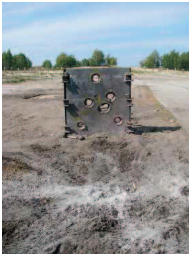
Rys. 10. Płyta pancerna po dniu badania skuteczności i celności ładunków EFP
