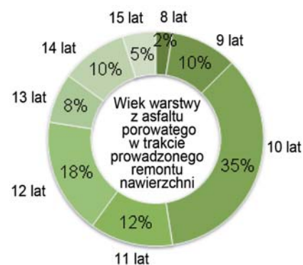
Rys. 4. Wiek warstw ścierną z asfaltu porowatego na autostradzie A 2 w trakcie prowadzonych prac remontowych
