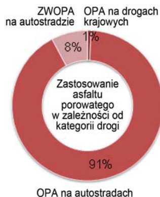
Rys. 3. Zastosowanie warstwy ścierną z asfaltu porowatego na terenie Dolnej Saksonii
