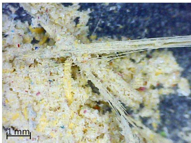
Rys. 3. Pył po laminacie, mikroskop optyczny, pow. 20×
