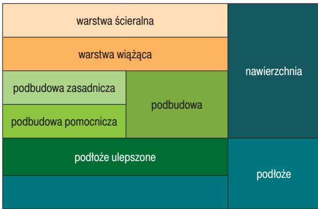
Ryc. 1. Schemat konstrukcji nawierzchni drogowej [3]
