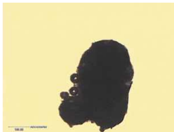
Rys. 4. Konglomerat różnej wielkości mikrosfer. Próbka surowa. 1N Fig. 4. Conglomerate of different size of cenospheres. Raw sample. 1N
