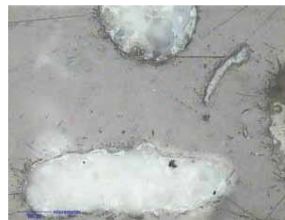
Rys. 16. Plerosfera. Próbka surowa. 1N Fig. 16. Plerosphere. Raw sample. 1N
