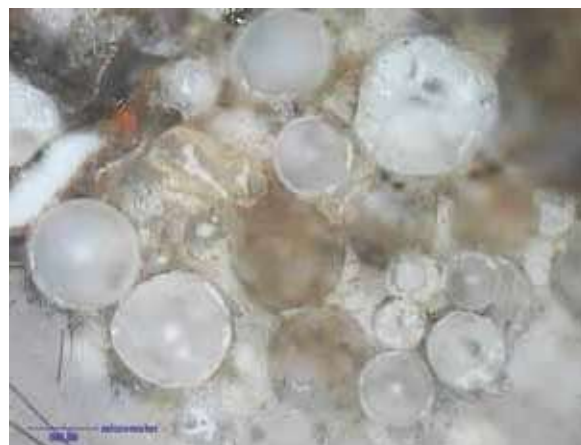
Rys 14. Różnej wielkości mikrosfery. Próbka surowa. 1N Fig. 14. Different size of cenospheres. Raw sample. 1N
