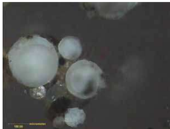
Rys. 11. Mikrosfery i hematyt. Klasa ziarnowa 0,5 - 0,045 mm. NX
