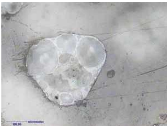
Rys. 17. Plerosfera. Klasa ziarnowa 0,5-0,045mm. 1N Fig. 17. Plerosphere. Grain class 0.5 - 0.045 mm. 1N
