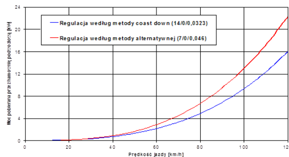
Rys. 4. Porównanie krzywych mocy pobieranej przez hamownię podwozową dla samochodu typu A, uzyskanych metodą coast down (krzywa 14/0/0,0323) i alternatywną (krzywa 7/0/0,046)
