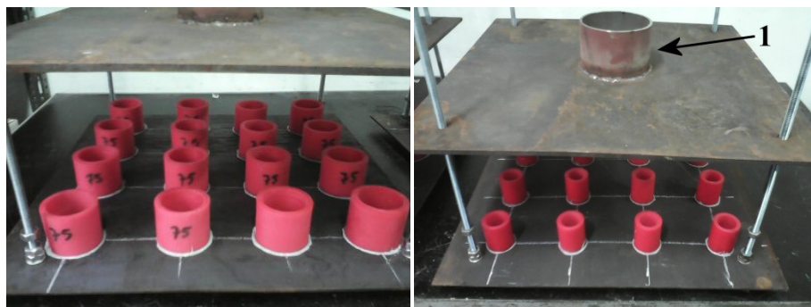
Rys. 9. Badane układy materiałowe, w trakcie montażu: 1 – tuleja centrująca
