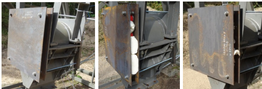
Rys. 1. Badane układy materiałowe zamontowane od strony gniazda moździerzka wahadła balistycznego
