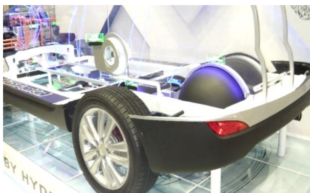
Rys. 2. Hyundai ix35 FC, w tym sposób lokowania zbiornika CH 2 [materiały własne]
