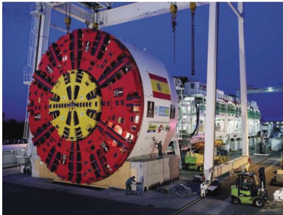
Rys. 5. Maszyna Herrenknecht S-300 EPB TBM typu dual mode o średnicy 15,12 m
