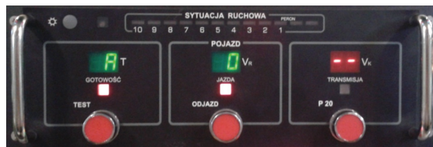
Rys. 5. Pulpit maszynisty systemu SOP-2 w pociągach typu 81 i Metropolis
