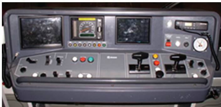
Rys. 6. Pulpit maszynisty systemu SOP-2P w pociągu 81M w Pradze
