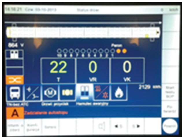
Rys. 7. Pulpit maszynisty systemu SOP-3 w pociągu Inspiro
