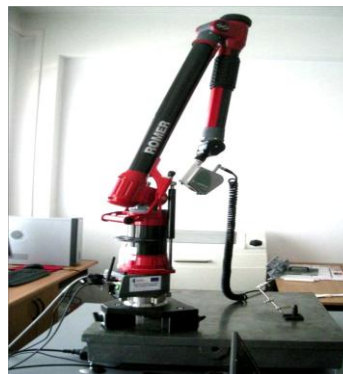
Rys. 14. Ramię pomiarowe CimCore Romer Ininity 2 z głowicą skanującą Contur Probe [23, 24].
