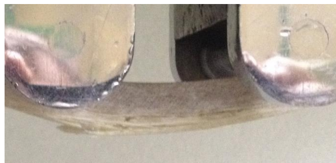
Rys. 7. Złom próbki z laminatu podczas próby zginania
