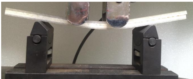
Rys. 8. Złom próbki z kompozytu przekładkowego podczas próby zginania czteropunktowego
