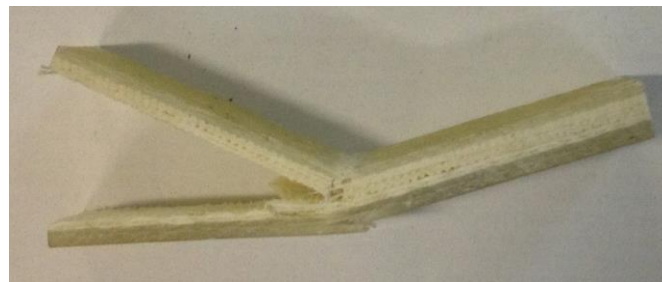
Rys. 4. Złom próbki z kompozytu przekładkowego
