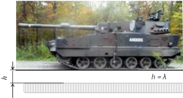
Rys. 6. Schemat wyznaczania jednostkowej energii potencjalnej zawieszenia
