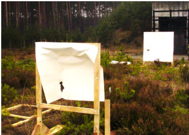
Fot. 8. Stanowisko do badań stabilności pocisku EFP na torze lotu (strzał 4)
