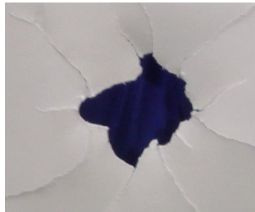
Fot. 10. Przykłady przebicia tarczy papierowej przez pociski uformowane wybuchowo Photo 10. Examples of paper screen punctures by explosively formed projectiles
