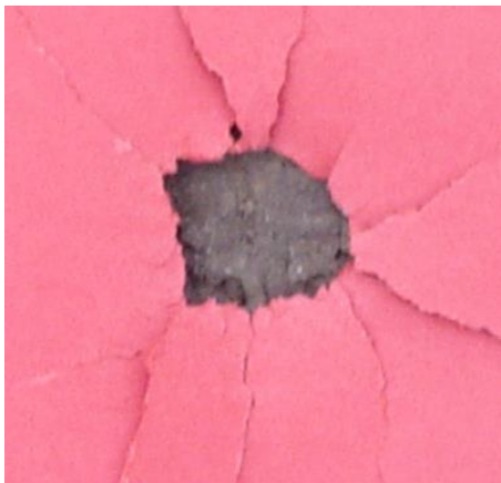
Fot. 10. Przykłady przebicia tarczy papierowej przez pociski uformowane wybuchowo Photo 10. Examples of paper screen punctures by explosively formed projectiles
