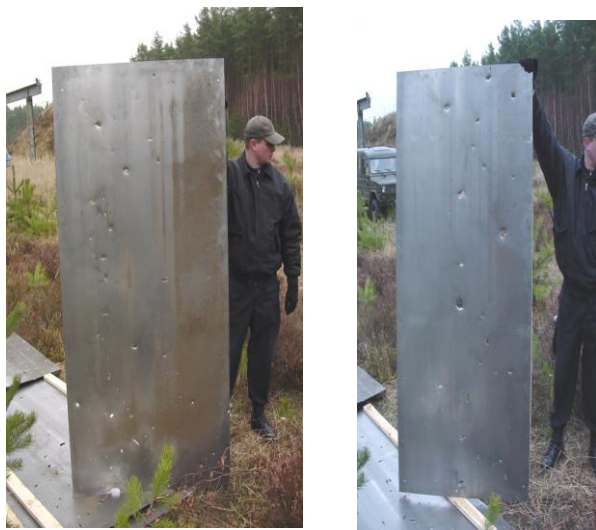
Fot. 12. Przykładowe wyniki badań odłamkowości względnej ładunków EFP wariant G1 – z lewej, wariant G1A - z prawej
