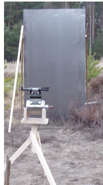
Rys. 11. Stanowisko do badania odłamkowości względnej (na ładunku widoczny jest celownik przeziernikowy)
