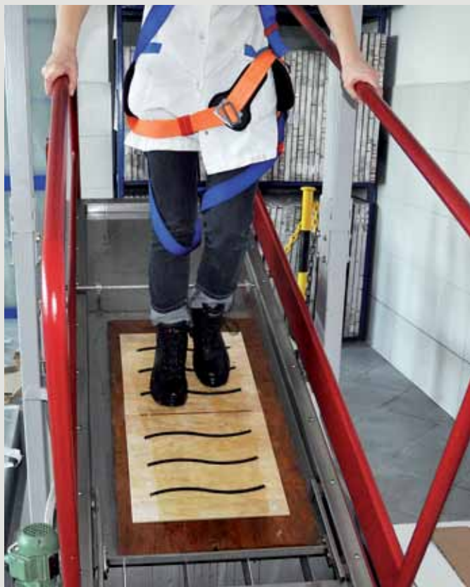
Fot. 1. Platforma do badania antypoślizgowości płytek ceramicznych.
