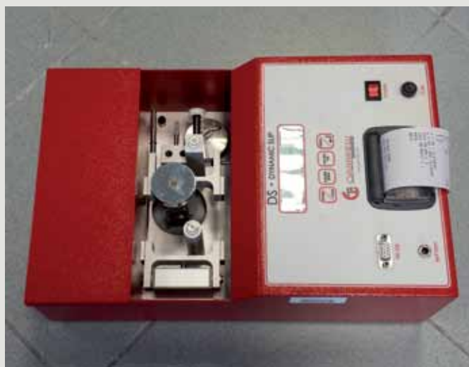
Fot. 2. Urządzenie do określania dynamicznego współczynnika tarcia.
