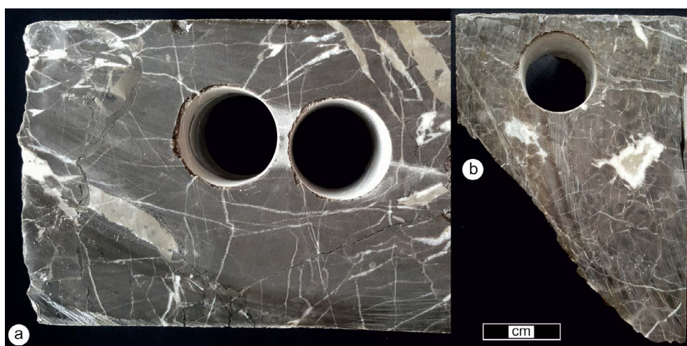
Rys. 3. Wybrane próbki rdzeni z otworu Biały Dunajec PAN-1 z widocznymi żyłami i skupiskami kalcytu a) wapień dolomityczny, 2161–2168 m p.p.t.; b) wapień dolomityczny, 2210–2223 m p.p.t.
