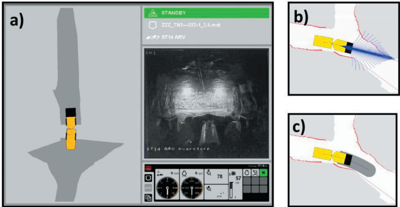
Rys. 3. Ładowarka pracująca w systemie telesterowania w podziemnym wyrobisku górniczym [20]
