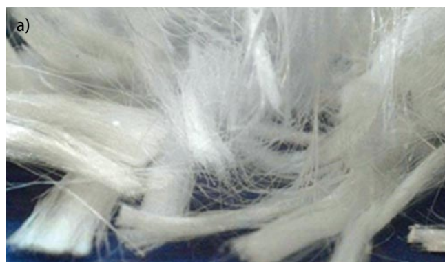
Rys. 1. Mikrowłókna polipropylenowe: a) pojedyncze klasy Ia, b) fibrylowane klasy Ib
