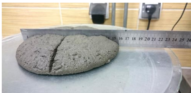
Rys. 10. Pomiar średnicy próbki świeżej zaprawy cementowej z dodatkiem PCM
