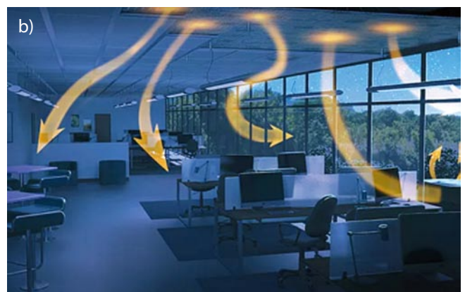
Rys. 1. Aktywne pochłanianie i uwalnianie ciepła dzięki zastosowaniu ENRG Blanket™ od wewnętrznej strony sufitu podwieszanego: a) pochłanianie i magazynowanie ciepła, b) uwalnianie zgromadzonej energii (źródło: Phase Change Energy Solutions)
