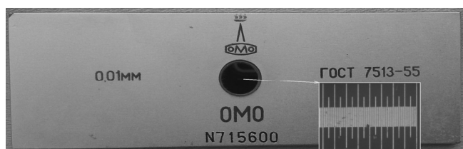
Rys. 1. Wzorec kreskowy 1 mm Fig. 1. Stage object micrometer 1×0,01 mm reflected light
