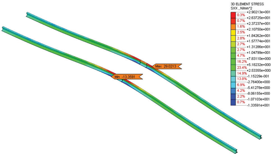
Rys. 6. Maksymalne naprężenia w szynach otrzymane dla przypadku realnego letniego
