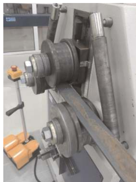
Rys. 11. Rolki monolityczne wykorzystane do badań zamontowane na walcarki trójrolkowej z badanym płaskownikiem
