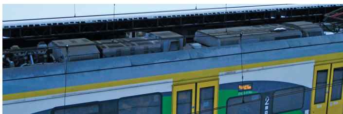
Rys. 1. Wyposażenie na dachu w pasażerskiej jednostce trakcyjnej
