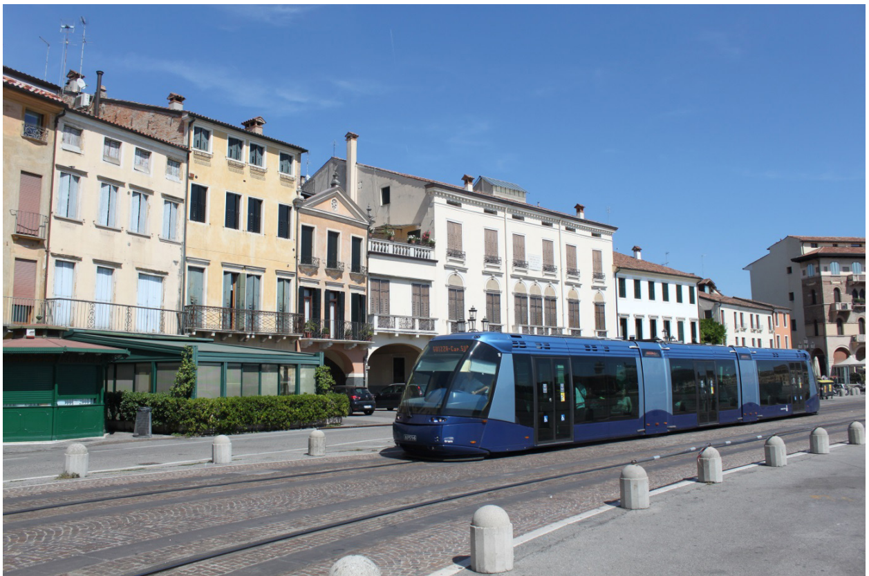
Fot. 3. Linia tramwaju na oponach typu Translohr w Padwie biegnący przez zabytkowe śródmieście miasta, gdzie z względów estetycznych zrezygnowano z sieci trakcyjnej na rzecz baterii, fot. Jakub Taczanowski, 18.08.2017.
