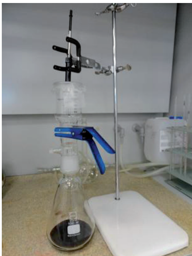
Rysunek 2 Zestaw do oznaczenia barierowości powłok ochronnych Figure 2 Kit for determination of barrier properties of protective coatings
