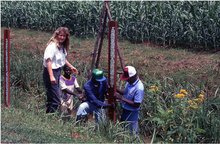
Rys. 7. Instalacja wodowskazu Nyamugali.
