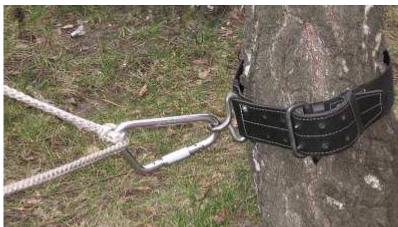
Fot. 4. Węzeł mocujący w stałym punkcie asekuracji
