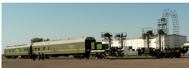
Wagony (od lewej): elektrownia, wagon termostatujący oraz platforma z rękawkami służącymi do tłoczenia chłodzącego powietrza, tzw. energopojezd (8.07.2011 r.) Fot. ze zbiorów M. S. Mukownina
