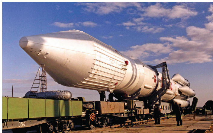
Rakietą nośną Proton w kompleksie transportowym, używana do wnoszenia między innymi satelitów. Ze względu na dużą moc, może być stosowana do wnoszenia ładunków o masie do 23 t, dla porównania maksymalny ładunek jaki może wynieść rakietą Sojuz to 5–7 t. Paliwo stosowane w rakiecie Proton to dwutlenek azotu i dimetylohydrazyna, obie substancje wysoce toksyczne, wymagające szczególnych środków ostrożności
