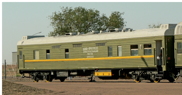
Wagon wyposażony w agregat spalinowy do wytwarzania energii elektrycznej zasilającej system regulacji temperatury rakiety podczas transportu (8.07.2011 r.) Fot. ze zbiorów M. S. Mukownina
