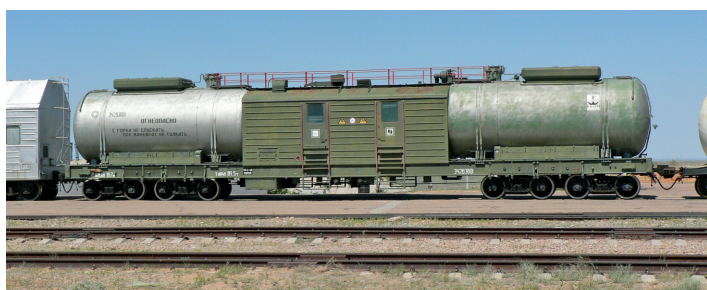
Wagon cysterna do transportu ropy do rakiet, wyposażony także w urządzenia do tankowania, i urządzenia bezpieczeństwa (22.05.2007 r.) Fot. ze zbiorów M. S. Mukownina
