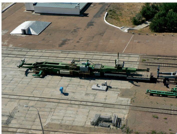
Wagon do transportu bezpośrednio samej rakiety; z lewej strony znajduje się spód rakiety, a z prawej wierzchołek; wagon widoczny na zdjęciu służy do transportu niewielkich rakiet o masie z paliwem 300 t (podobna rakietka bez paliwa ma masę 30 t); w przypadku stwierdzenia jakichkolwiek usterek rakiety, w pierwszej kolejności ze zbiorników usuwane jest paliwo – tragedia z 24.10.1960 r. pokazała, że jest to absolutnie konieczne (30.06.2009 r.) Fot. ze zbiorów M. S. Mukownina
