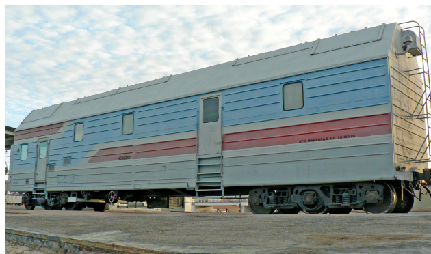
Wagon do przechowywania i transportu stężonego nadtlenu wodoru, utleniaacza stosowanego w silnikach rakiety, wyposażony w pompy i instalację do chłodzenia utleniacza, a także zabezpieczenia przed wniknięciem substancji organicznych (stężony nadtlenek wodoru mógłby wtedy eksplodować, 19.10.2010 r.) Fot. ze zbiorów M. S. Mukownina
