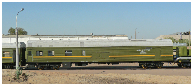
Wagon używany do utrzymywania stałej temperatury części rakiety – w zimie ogrzewania elektrycznego, w lecie chłodzenia zimnym powietrzem (8.07.2011 r.) Fot. ze zbiorów M. S. Mukownina
