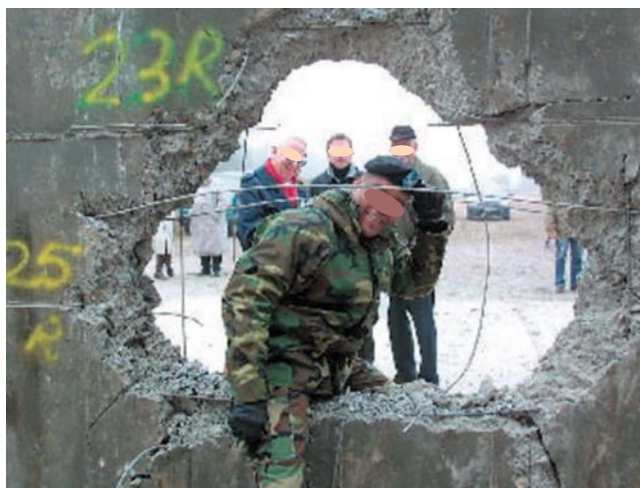
Rys. 3. Efekt penetracji 120 pocisku PELE-FSDS (Fin Stabilised Discarding Sabot) [5]
