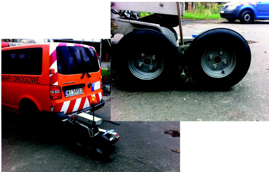
Fot. 3. Urządzenie TWO. Widok ogólny samochodu z przyczepką do pomiaru współczynnika poślizgowości (tarcia) nawierzchni drogowych i lotniskowych (fot. P. Dąbkowski)
