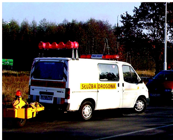
Fot. 2. Urządzenie SRT-3. Widok ogólny samochodu z przyczepką do pomiaru współczynnika poślizgowości (tarcia) nawierzchni drogowych (fot. S. Szpinek)
