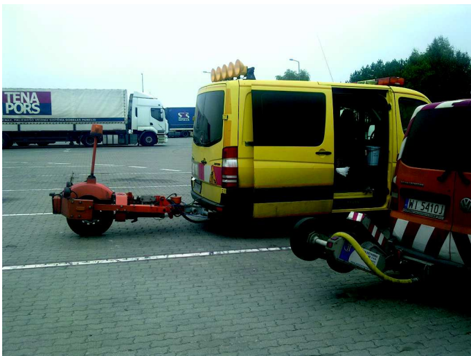
Fot. 1. Urządzenia SRT-3 i TWO. Widok ogólny przyczep do pomiaru współczynnika poślizgowości (tarcia) nawierzchni drogowych (fot. S. Szpinek)
