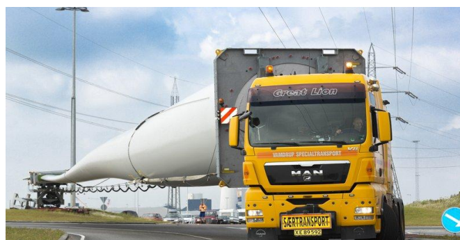
Rys. 1. Transport pojedynczej łopaty elektrowni wiatrowej
