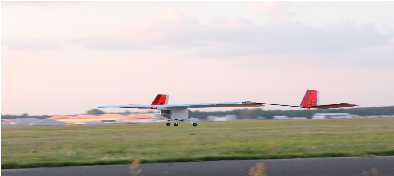
Rysunek 5 Model samolotu w układzie OHS, który był wykorzystywany podczas zawodów Air Cargo Challenge 2013 w Lizbonie [7]
