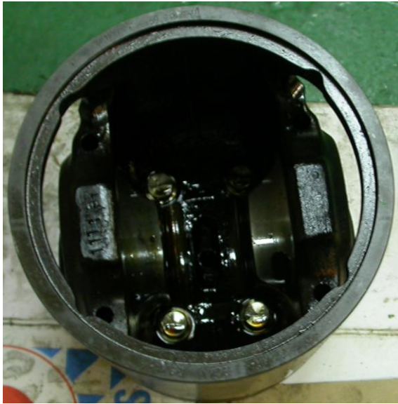
Fig. 9. Damaged cylinder liner Rys. 9. Uszkodzona tuleja cylindrowa
