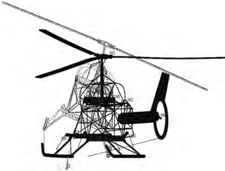
Rys. 25. Widok modelu śmigłowca na początku analizy (kolor czarny przerywany) oraz na końcu (kolor czarny)
