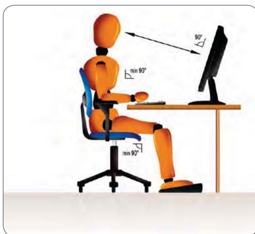
Rys. 3. Ustawienie monitora względem oczu i głowy Fig. 3. Positioning the monitor in relation to the employee
