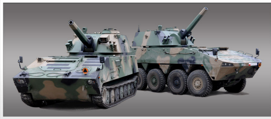
Rys. 1. 120 mm samobieżny moździerz na podwoziu kołowym i gąsienicowym
