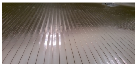
Rys.5. Częściowo roztopiony PCM wewnątrz poliwęglanu komorowego
