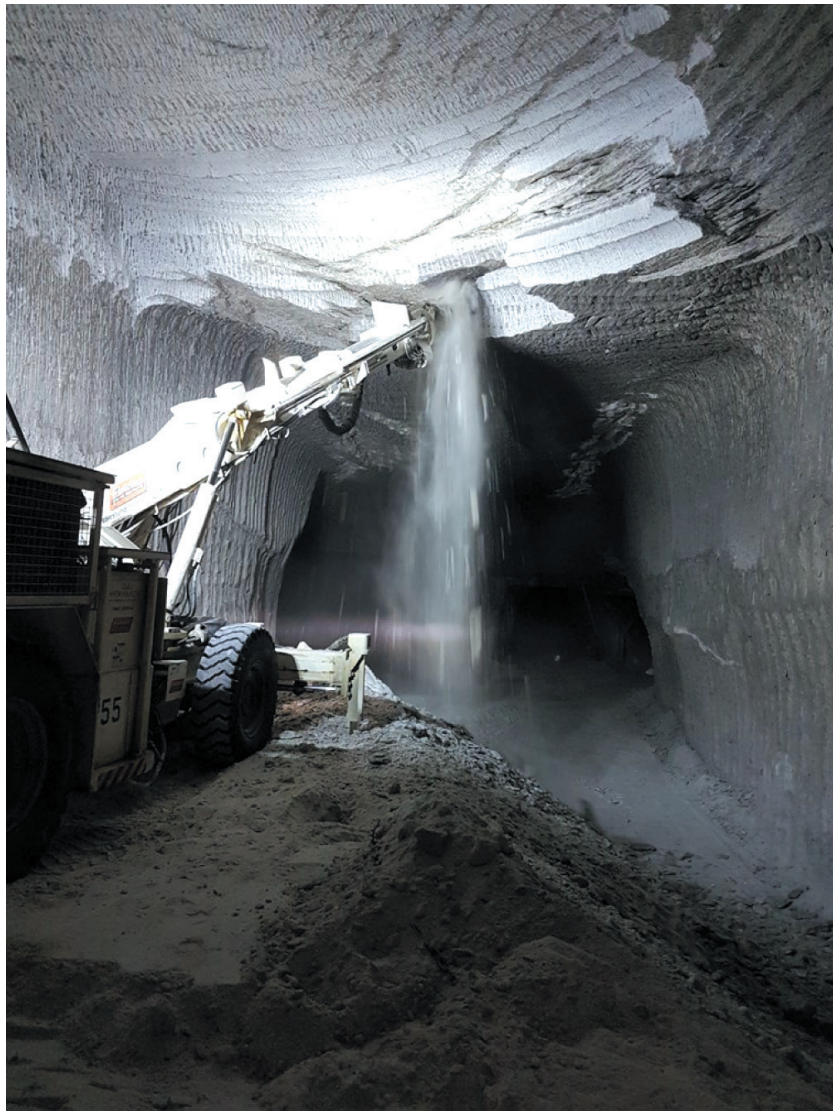
Rys. 15. Maszyna SWBF-3230-AD samojezdny wóz do obrywki
