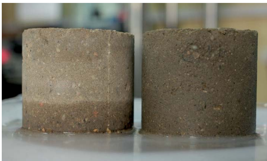
Fot. 1. Próbkę po 24 h badaniu odporności na absorpcję kapilarną wody – po lewej stabilizacja dodatkami zwiększającymi odporność na absorpcję, z prawej próbka stabilizowana cementem (fot. Nascon)
