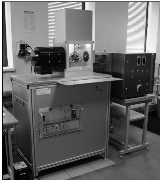
Rys. 1. Stanowisko SRV do tribologicznych badań materiałów konstrukcyjnych w wysokiej temperaturze
