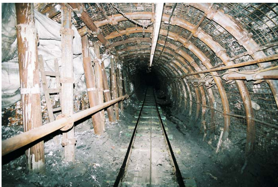
Rys. 24. Widok chodnika 23b w pokładzie 405/1 po wykonanej pobierze spągu przed wybieraniem kolejnej ściany (Matuszewski i in. 2006)
