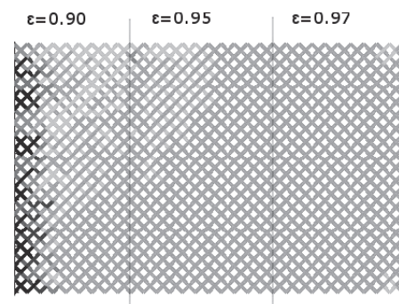
Rys. 7. Struktura filtra o konfiguracji warstw (3-2-1) po zakończeniu symulacji. Pory zablokowane (kolor ciemniejszy). Jedynie pierwsza warstwa struktury filtra zablokowana
