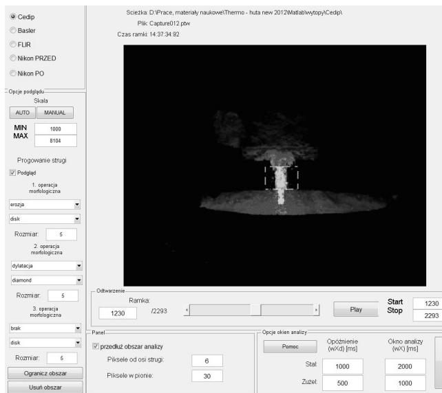
Rys. 4. Okno interfejsu użytkownika programu Slagizer ® do określania obszaru strugi oraz ustawiania parametrów jej progowania
