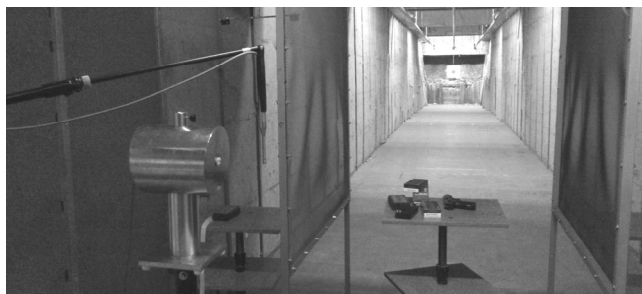
Rys. 2. Tester akustyczny z zainstalowaną wkładką przeciwhałasową i mikrofonem do pomiarów narażenia na hałas impulsowy na strzelnicy zamkniętej
