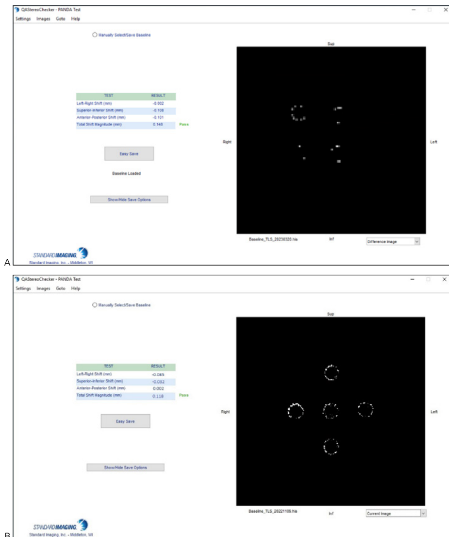
Ryc. 15 Okno oprogramowania QASC z wynikami obrazu testowego PANDA dla systemu CyberKnife; A) model VSI, B) model M6 i S7 Źródło: Materiały własne.
